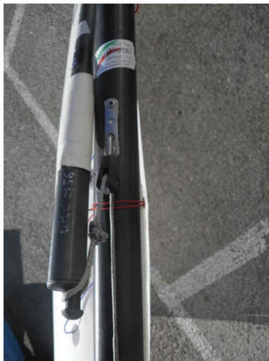
Προστατευτικό κάλυμα στο σημείο επαφής με το άλμπουρο
